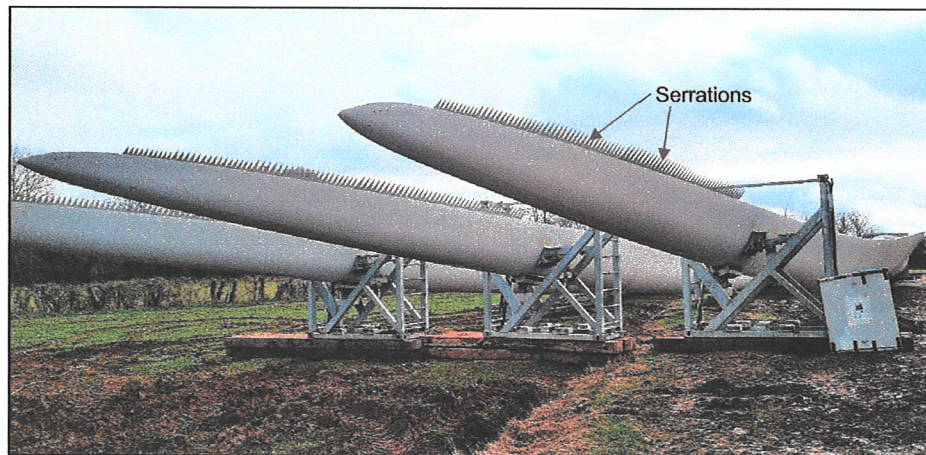
FIGURE 11 PRÉSENTATION DES SERRATIONS SUR PALES D'ÉOLIENNE
